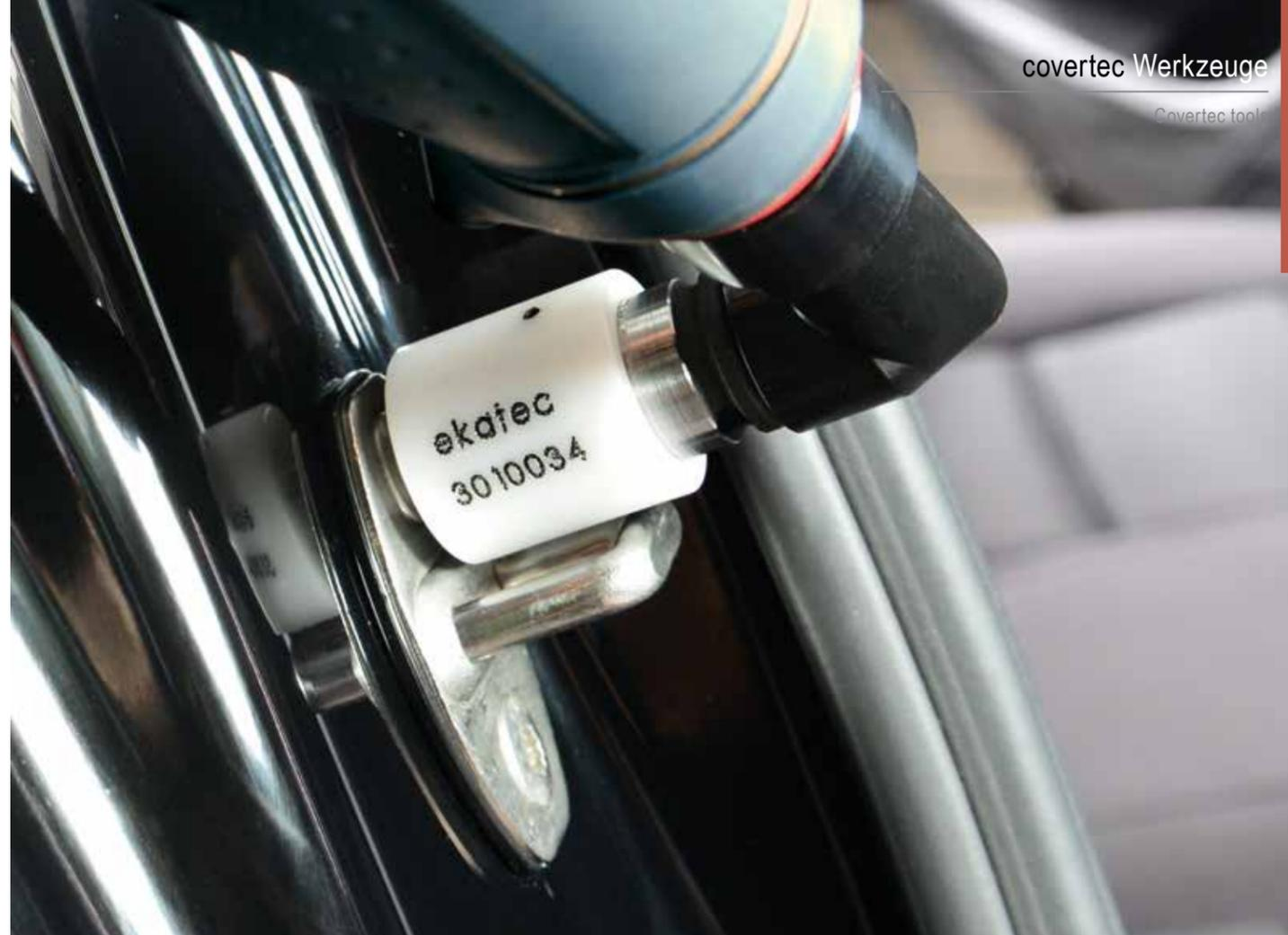
Steckschlüssel 6-kant dünnwandig, Pinch-point
